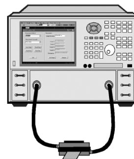
Рисунок 7. Объемный резонатор, подключенный между портами анализатора цепей.
