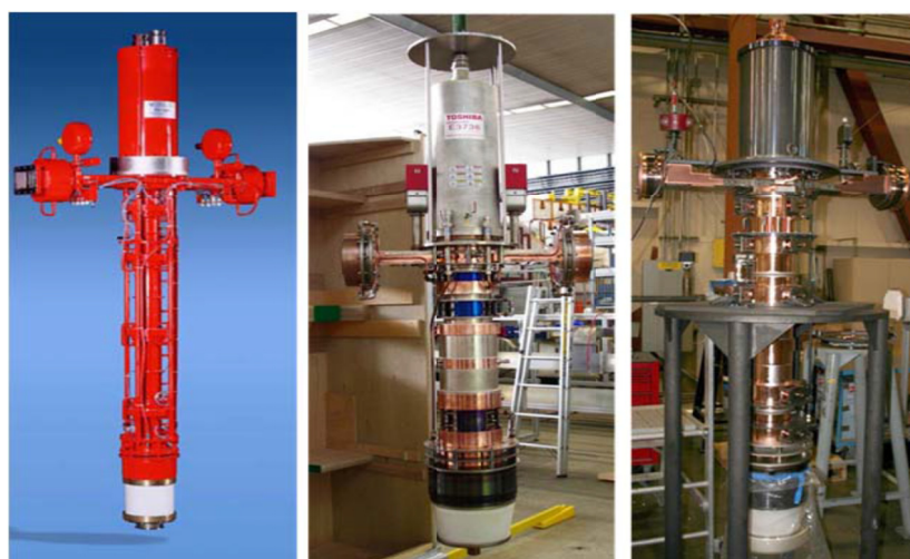
Рис. 1. Промышленно выпускаемые клистроны L-диапазона с КПД от 65% до 70%, слева направо: Thales TH1801, Toshiba E3736, CPI VKL-8301
